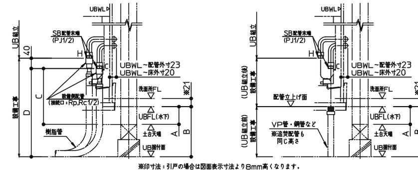
※印寸法：引戸の場合は図面表示寸法より8mm高くなります。
